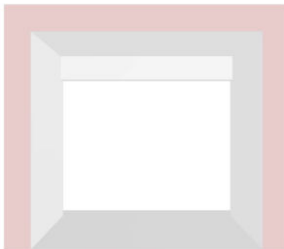
B) S CHYBĚJÍCÍM LEVÝM A PRAVÝM OSTĚNÍM
