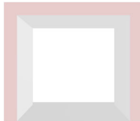
C) S CHYBĚJÍCÍM OSTĚNÍM A NADPRAŽÍM
